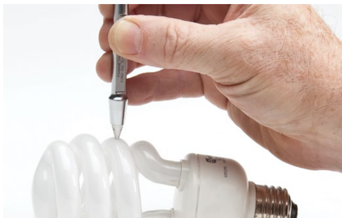
La opción de software de Alta resolución permite medir el espesor con una resolución de hasta 0,001 mm.
