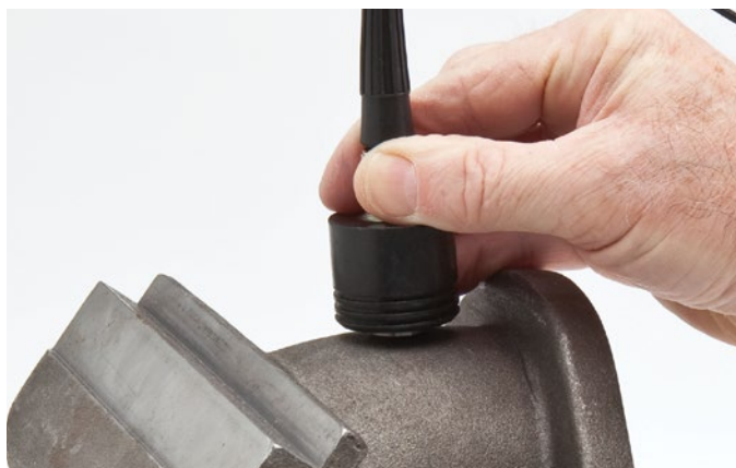
La opción de software de Alta penetración posibilita la medición de varias piezas de fundición metálica y materiales de atenuación acústica.
