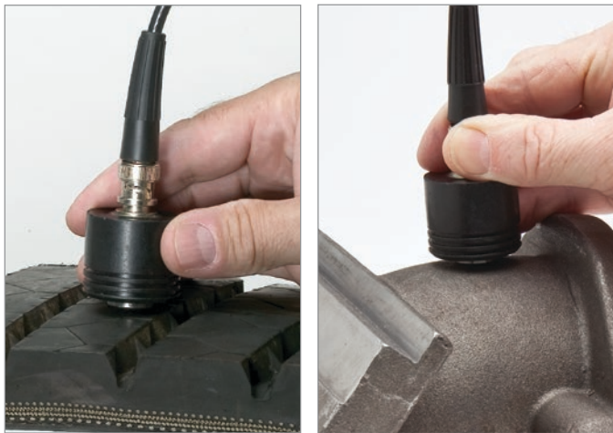
Medición de la profundidad hasta las bandas de tela con cordones de acero en bandas transportadoras o neumáticos de goma. Piezas de fundición o materiales altamente atenuantes pueden ser medidos en su mayoría con la opción software de Alta penetración.
