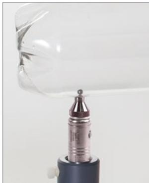
En las mediciones de estas piezas, tales como los recipientes de plástico, necesitas tan solo colocar la esfera dentro del recipiente. La sonda magnética, colocada al exterior de la pieza, atraerá dicha esfera. Esta última sigue el recorrido de la sonda hasta en las inspecciones de superficies o esquinas de geometría
